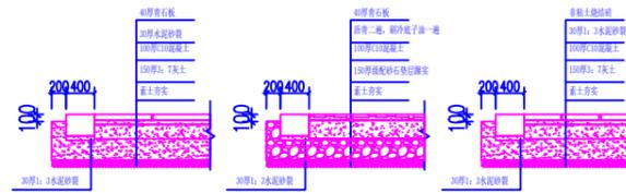
1-1、5-5、6-6断面图 1: 20 4-4断面图 1: 20 7-7断面图 1: 20
